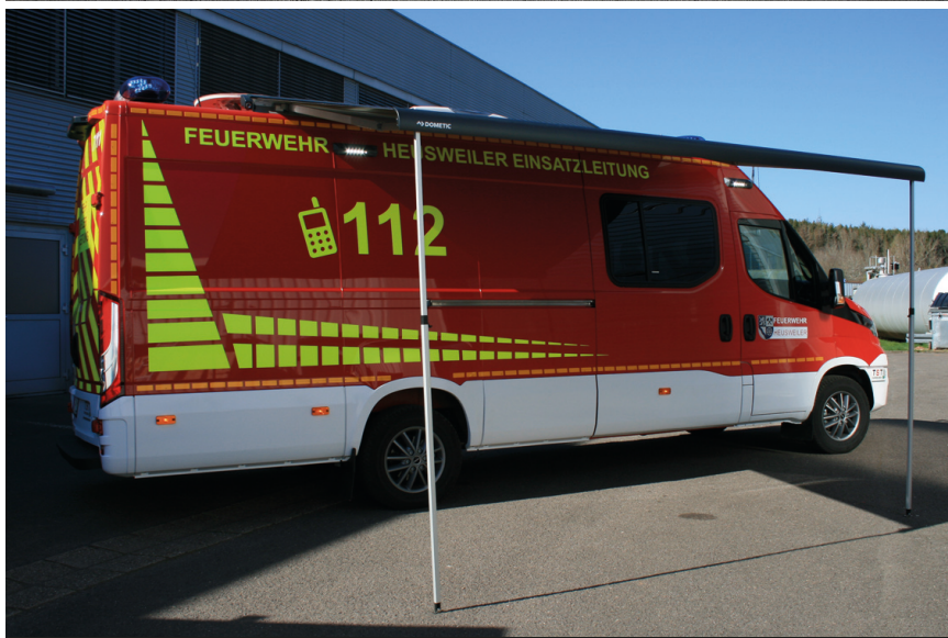
oben: ELW 1 auf Iveco Daily sind selten. Die FF Heusweiler erhielt einen ELW 1 von TST Fahrzeugbau. unten: Eine Markise bietet bei Besprechungen Wetterschutz. (Werkfotos)
